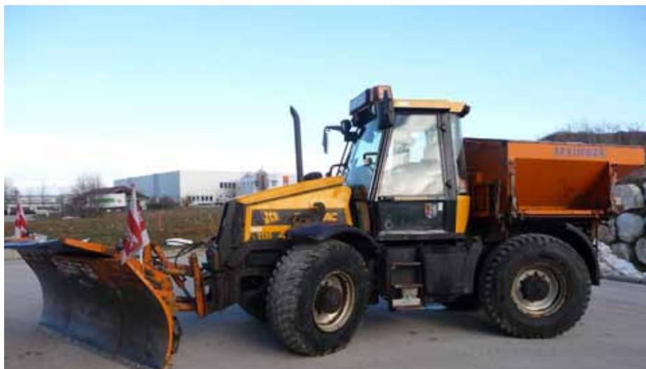
Der JCB 2135 4WS, Baujahr 2000 mit 8300 Betriebsstunden verfügt über 155 PS (112 kW). Ausstattung: Allrad, Druckluftbremse, EHR, Fronthydraulik, Frontzapfwelle, gefederte Vorderachse, Klimaanlage, Luftsitz, 4 Rad-Lenkung, Ladepritsche. Das Lastschaltgetriebe ist defekt.
